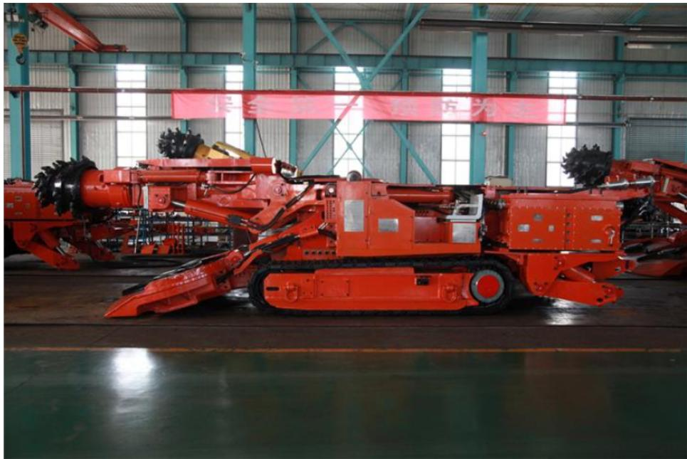
掘锚机产品规格和大零件技术说明：江苏佳煤机械有限公司掘锚机是为满足长壁开采技术需要，加快巷道掘进速度而设计的锚掘一体化快速掘进机。它具有连续采煤机的宽截割滚筒，并具有其独特的截割和装载设计性能。螺栓机是掘锚机的重要组成部分。掘锚机配备了四台顶板锚杆机和两台侧锚杆机。所有顶板锚杆机和侧锚杆机都布置在切割滚筒的后面。这种设计使掘锚机能够同时进行掘进和锚固作业。为了较大限度地改善操作人员的工作环境，掘锚机配备了防尘帘和集尘通道。该机集成熟技术于一体，行驶速度快。拥有多年经验的江苏佳煤机械有限公司，是行业先锋，理念先锋。掘锚机全称掘锚护一体机，该机由锚杆机和掘进机两部分组成。掘锚机配件厂家直销
